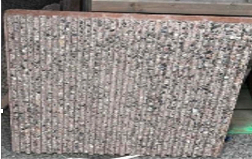
Materialprøve på pigmentert betong
